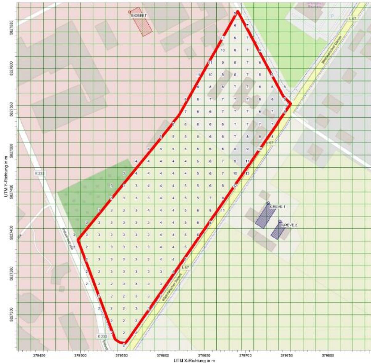
**Abbildung 1: Geruchsgesamtbelastung unter Berücksichtigung möglicher Geruchsemissionen des Biofilters der Firma Rengers.**
